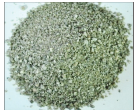
Fig 2: Ironmaking slag sand
