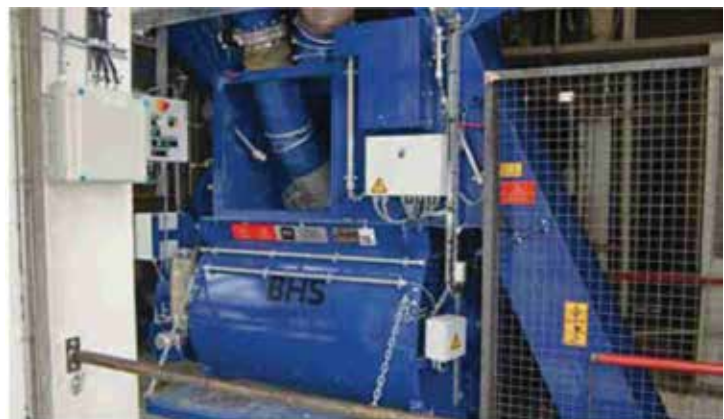
BHS mixing station with twin-shaft batch mixer (DKX), head piece of the skip conveyor and weighing conveyor. BHS-Mischstation mit Doppelwellen-Chargenmischer (DKX), Kopfstück der Aufzugsbahn und Waageeinläufe.
